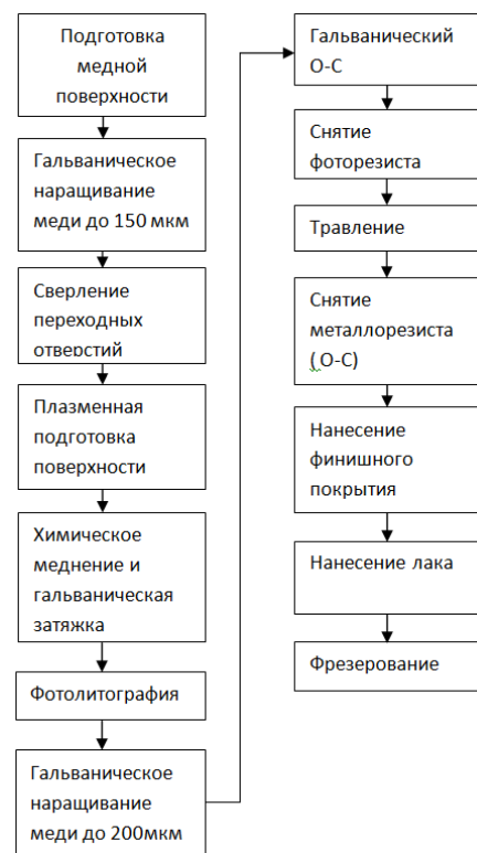
Рисунок 10 – Краткая блок-схема технологического процесса изготовления ГПП
